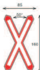
FIG. 10/c ART. 87 CROCE DI S. ANDREA INSTALLATA VERTICALMENTE obbligatorio in pellicola classe II
