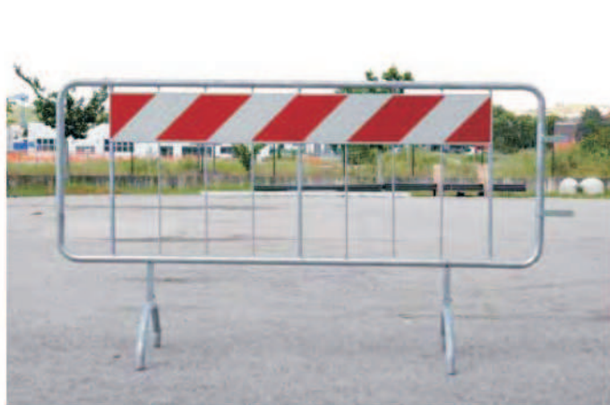
Fig. 2402: misura cm. 110x200 con nr. 6 tondini Ø 8, nr. 3 tubolari quadri 15x15, applicato pannello rifrangente 20x150.
