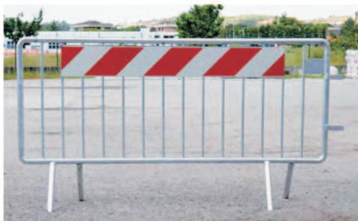
Fig. 2403E: misura cm. 110x250 con nr. 7 tondini Ø 8, nr. 3 tubolari quadri 15x15, applicato pannellorifrangente 20x150.
