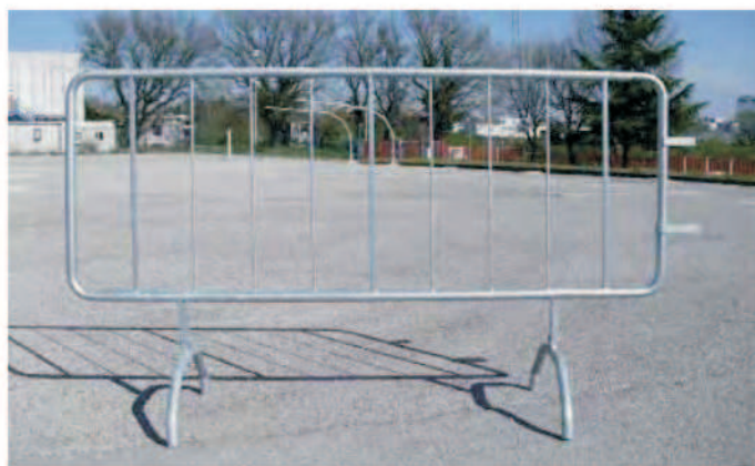
Fig. 2400: misura cm. 110x200 con nr. 6 tondini Ø 8, nr. 3 tubolari quadri 15x15, per eventuale applicazione pannello rifrangente 20x150.
